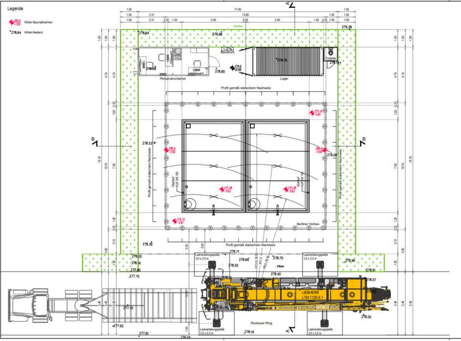
Tragwerksplanung des Baugrubenverbaus für den Einbau eines unterirdischen Löschwasserbehälters
