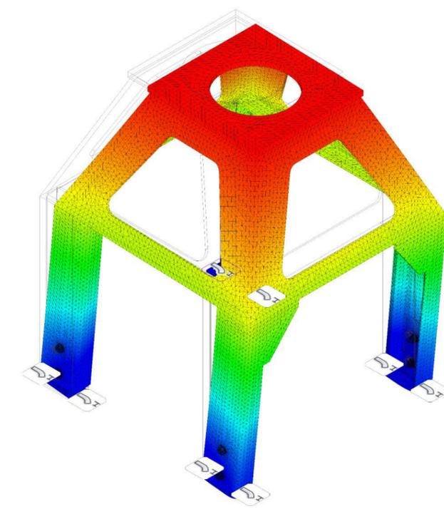
Modalanalyse (Ermittlung der Eigenschwingungen und Eigenfrequenzen) einer Pumpstation
